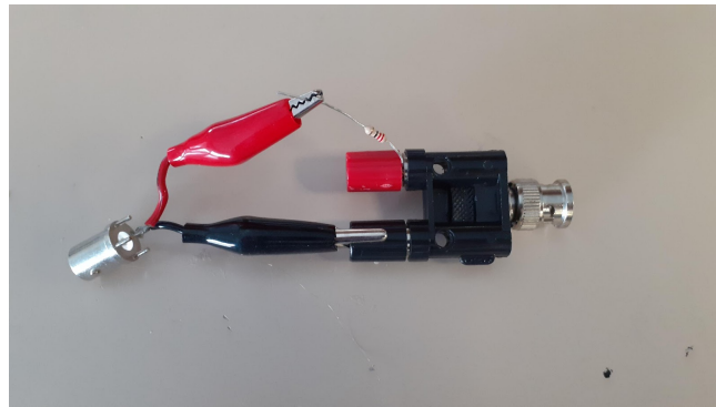
Figura 13: Collegamento resistenza in serie
