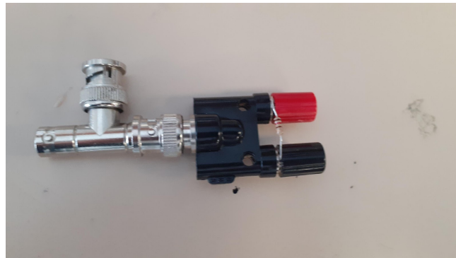
Figura 14: Collegamento resistenza in parallelo
